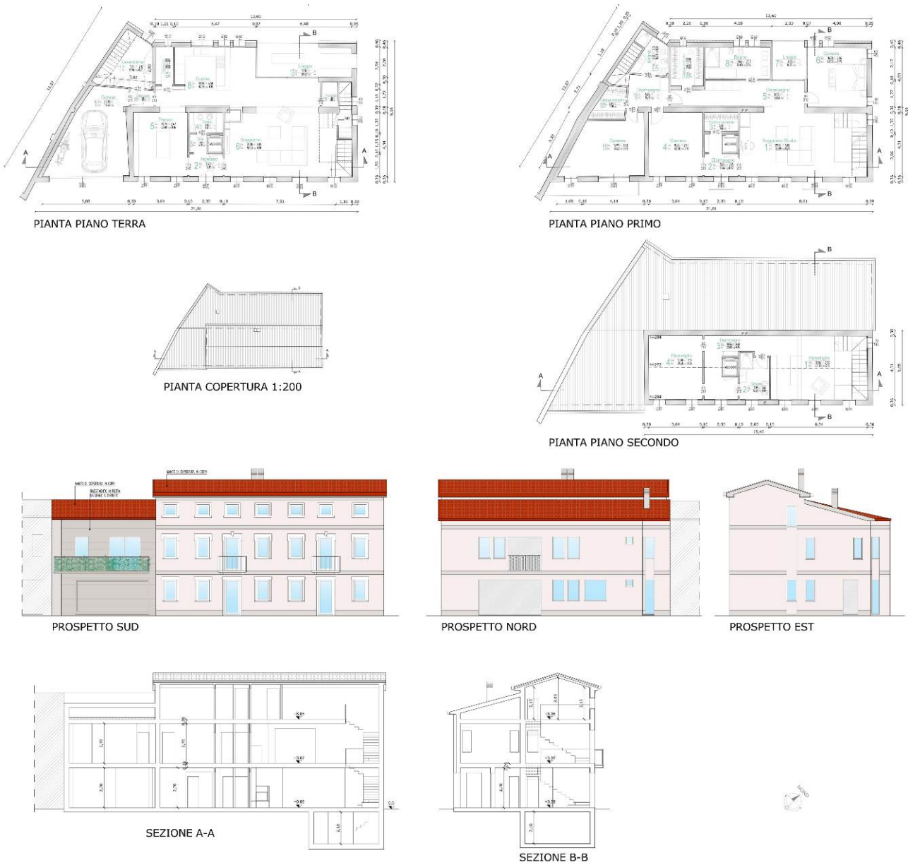
Figura 4: Stato modificato PdR (Fonte: Estratto modificato "Tavola 4: Piante, prospetti, sezione – Stato modificato")
