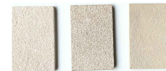
INTONACO PARETE INTERVENTO: RIMOZIONE COMPLETA E SUCCESSIVA POSA IN OPERA RIVESTIMENTO IN PIETRA NATURALE A CORRERE TIPO "BIANCO D'ISTRIA" O "DESERTO FAC BEIGE NAAN" BOCCIARDATURA LEGGERA*
