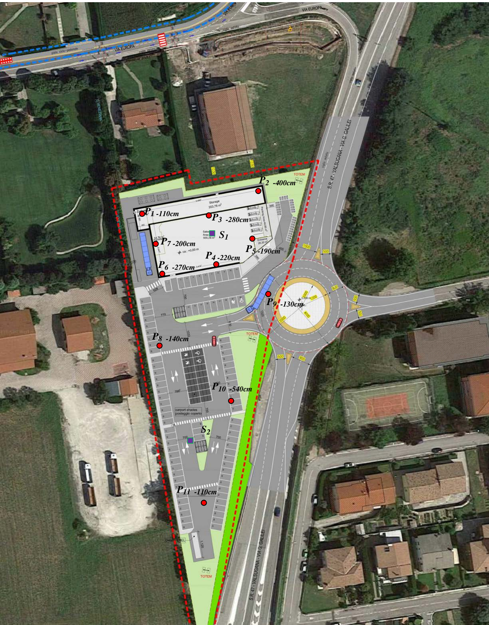
TAV.3 : Ubicazione dei sondaggi ambientali e delle prove penetrometriche con indicazione della profondità delle ghiaie dal p.c. su planimetria dell'intervento
