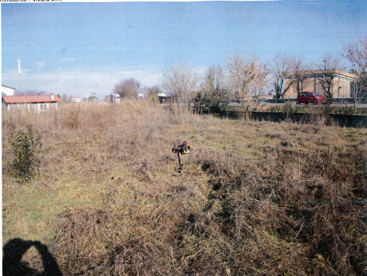
Foto N.3 : Esecuzione del Sondaggio ambientale N.2 nel settore meridionale dell'area di intervento
