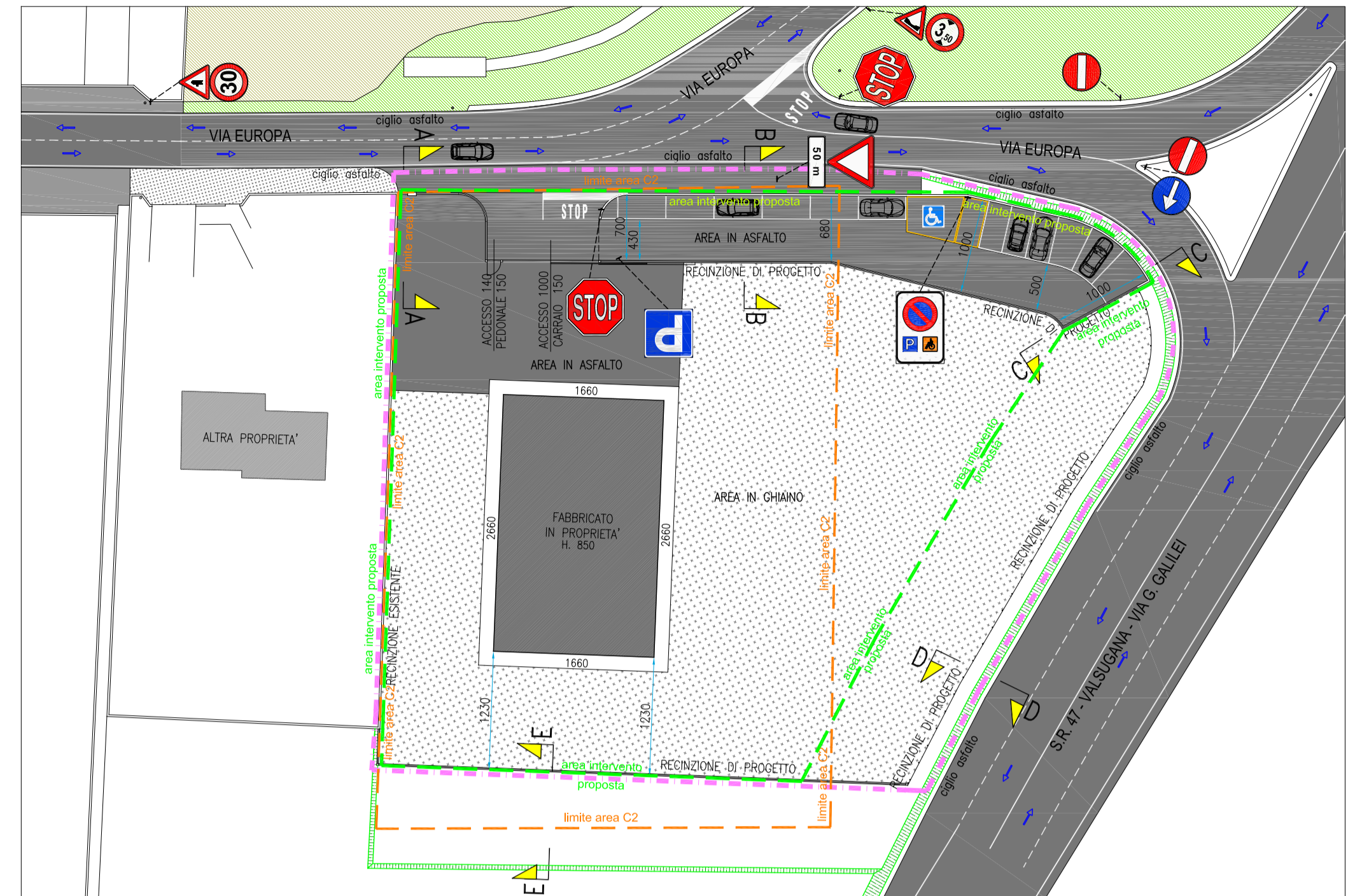
PLANIMETRIA VIABILITA' con nuovo perimetro area intervento proposta Stato di Progetto - Scala 1:500
