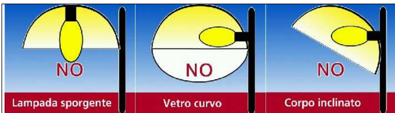
Figura 2.1 – Tipologie di apparecchi non ammessi (cortesia: CieloBuio)
