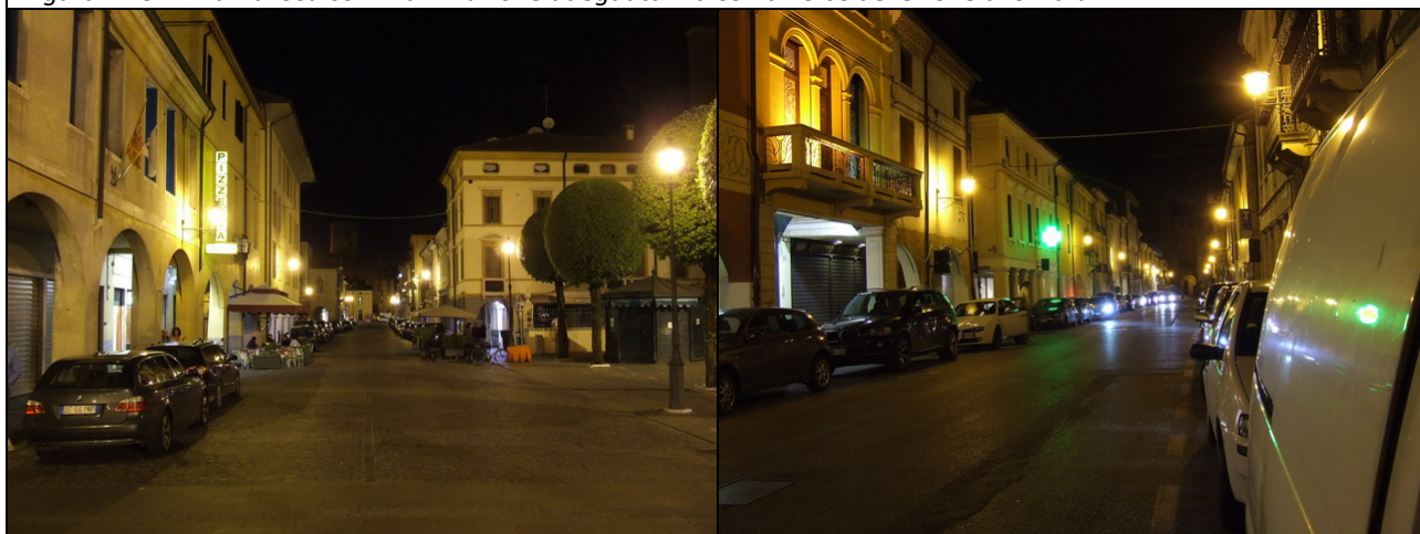
Figura 1.20 – Via Roma – Illuminazione abbagliante e a ridotto confort visivo – Al limite della sufficienza in termini di quantità
