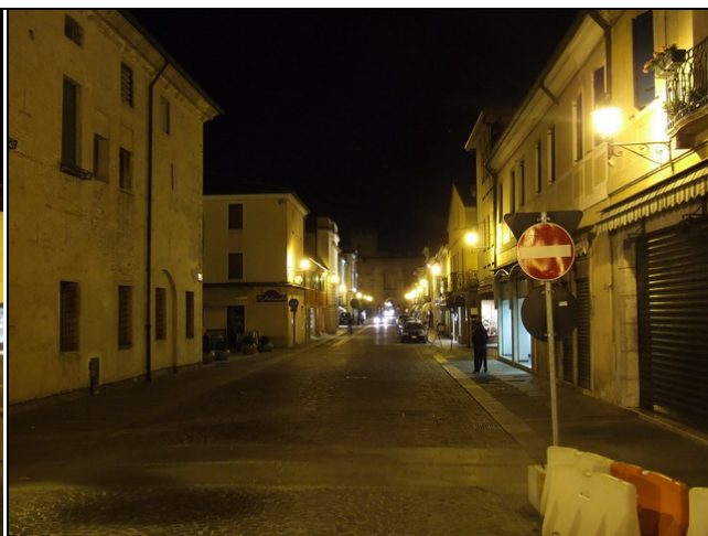
Figura 1.23 – Via Indipendenza - Illuminazione abbagliante e a ridotto confort visivo – Al limite della sufficienza in termini di quantità
