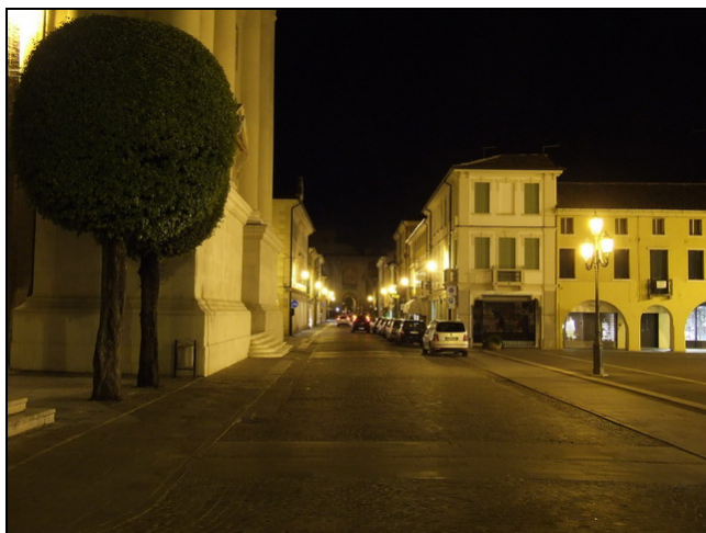
Figura 1.22 – Via Marconi - Illuminazione abbagliante e a ridotto confort visivo – Al limite della sufficienza in termini di quantità
