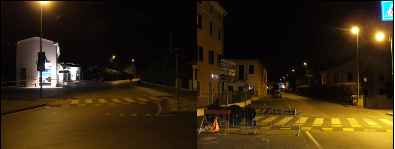
Figura 1.31 – Via Riva di Postumia – Illuminazione ridotta e non uniforme
