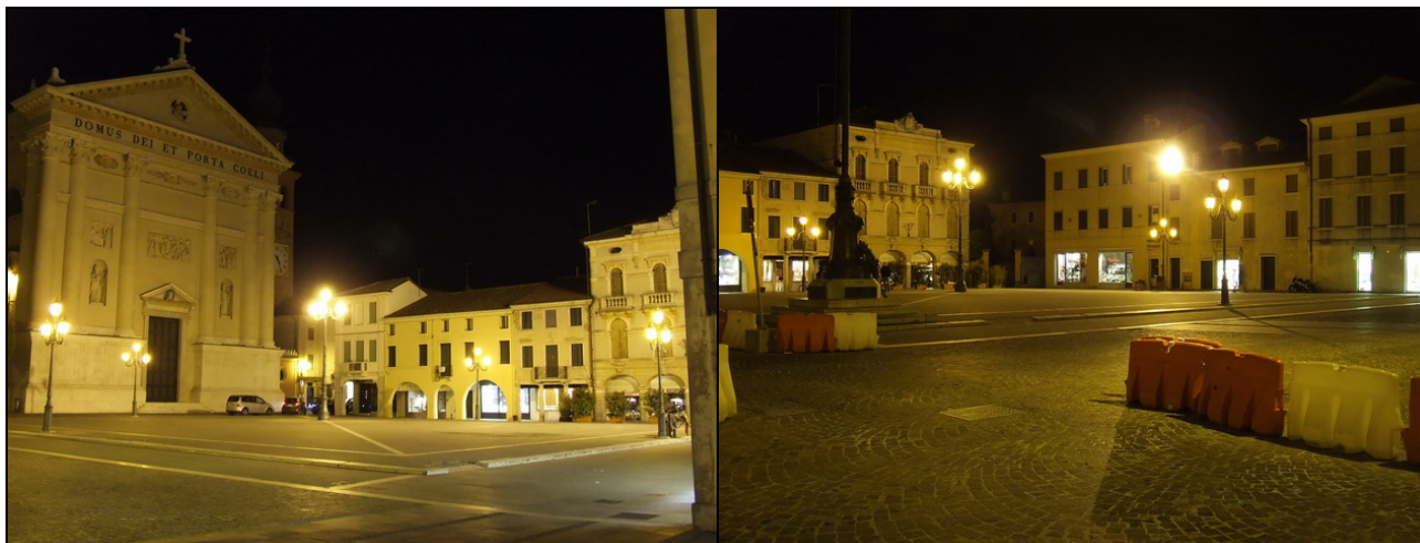
Figura 1.18 – Piazza Pierobon – Illuminazione al suolo tendenzialmente uniforme ma fortemente abbagliante e di un unico colore con ridotto confort visivo.
